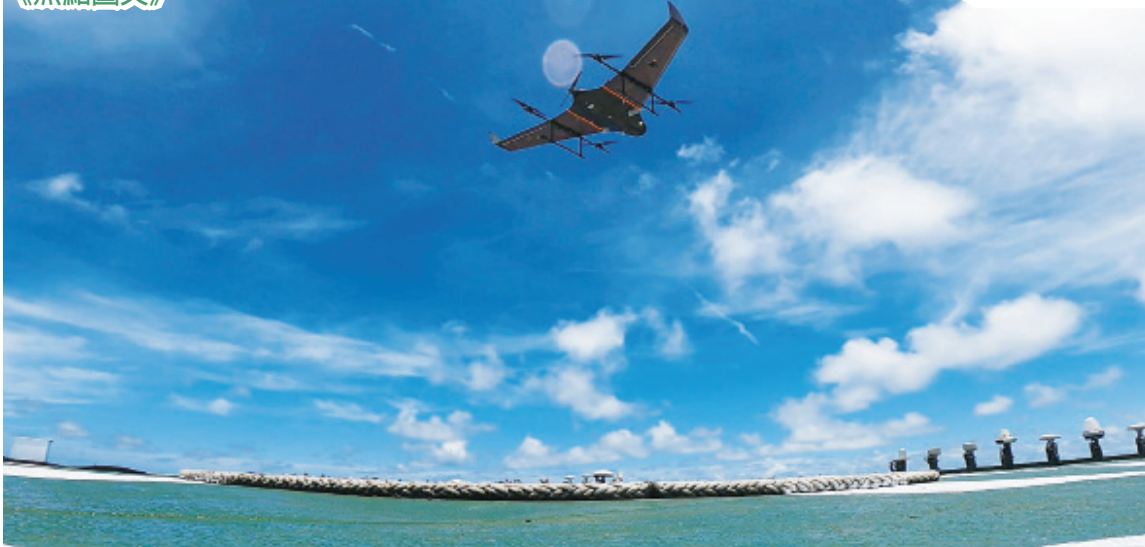
▲ 工業技術研究院與金屬工業研究發展中心發展遠洋漁業低破智慧漁搜無人機隊系統，正在進行相關測試驗證。(金屬中心提供)
