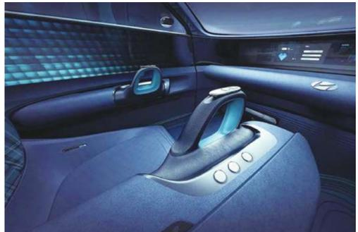
▲ 法拉利提出搖桿控制式轉向，無方向盤設計。(網路截圖)
