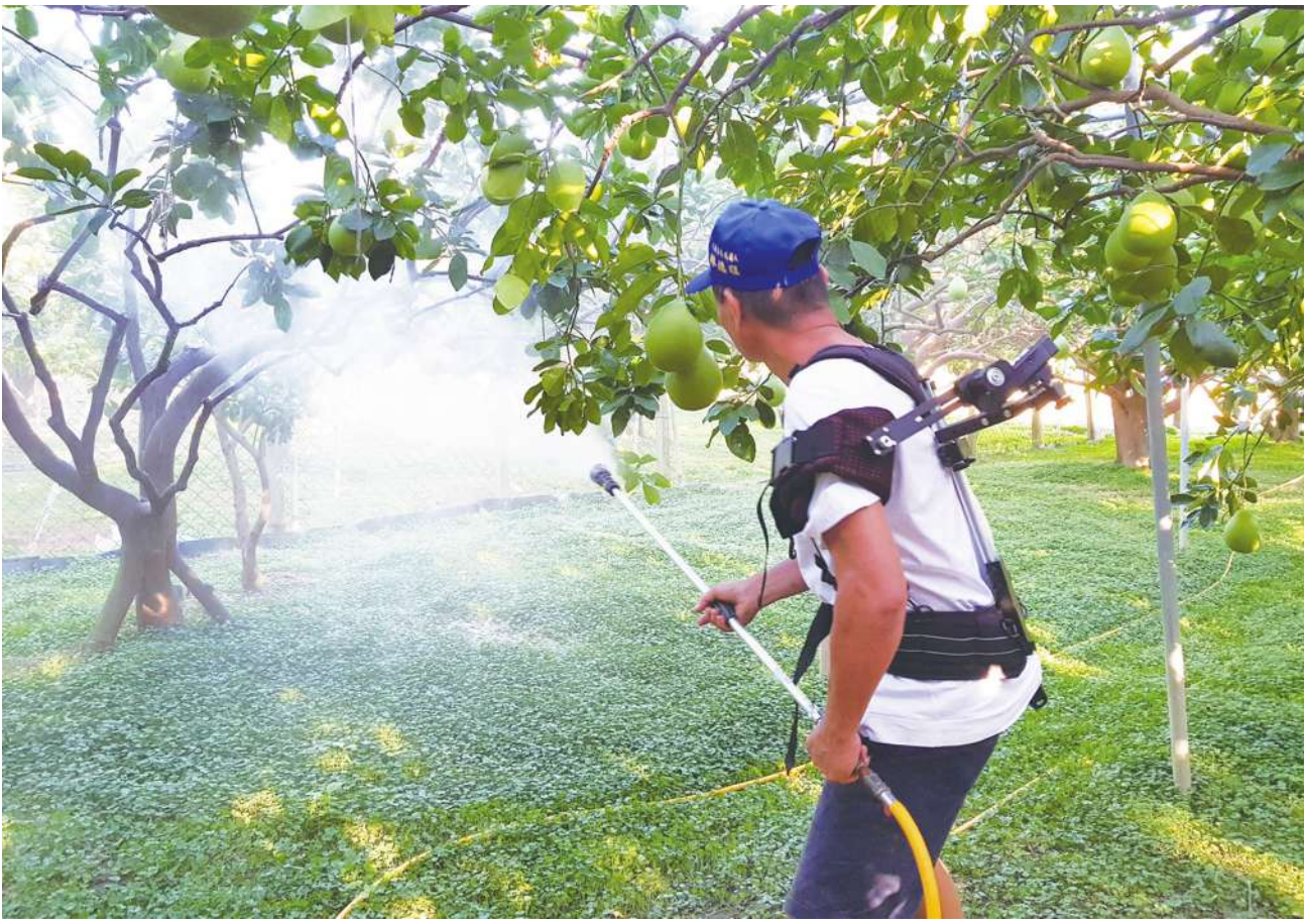
▲ 本套機具沒有使用傳統的馬達動力模式，因此不需要充電與保養，使用者也不必背負電池與馬達，承受額外的重量和體力消耗。(photo by 行政院農業委員會)
