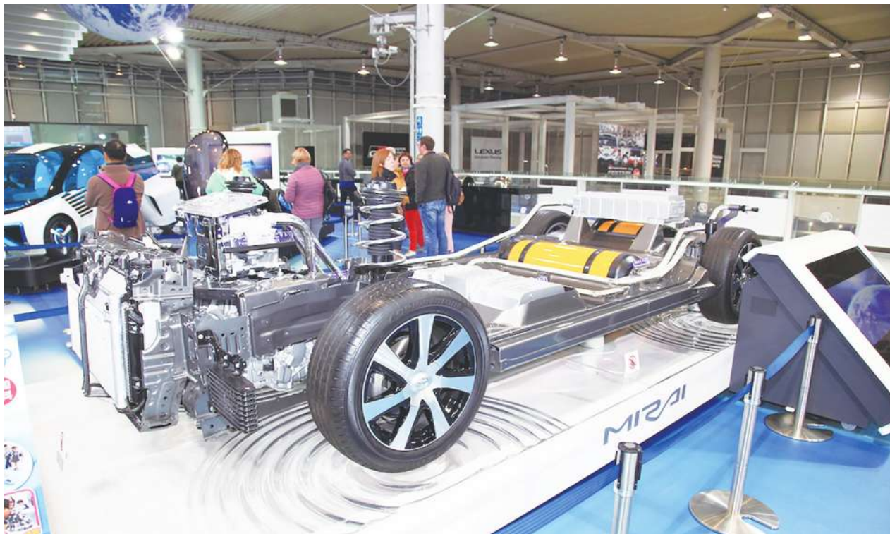
▼Mirai 第二代未來款式新底盤的設計讓配置在底板下方的「氫氣瓶」改採「T」字形擺放。(網路截圖)
