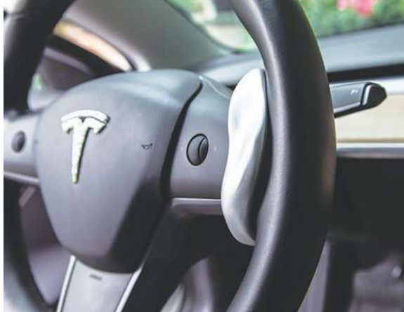
▲ 使用自動輔助駕駛時，使用方向盤配重環，反而讓駕駛有可能來不及接手方向盤而發生意外。（網路截圖）
