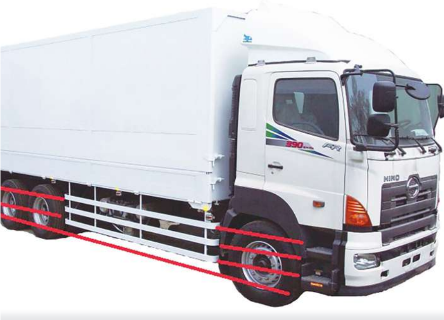
▲ 護欄式大車下擺，仍難防止異物鑽入車下。(網路截圖)
