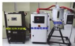
環保除濕輪熱泵整合乾燥系統
