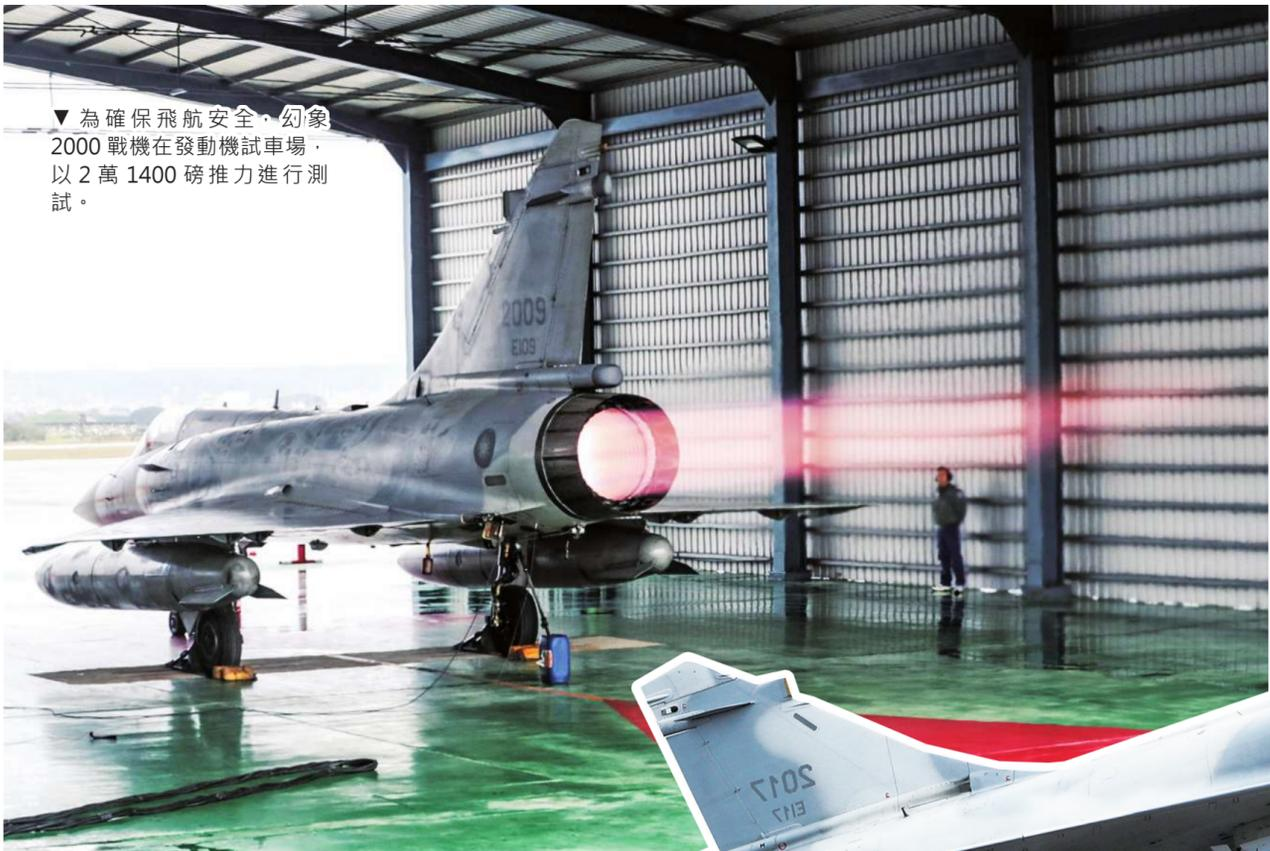
▼ 為確保飛航安全，幻象 2000 戰機在發動機試車場，以 2 萬 1400 磅推力進行測試。
