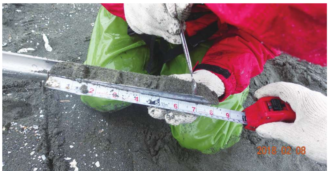
▲ 環保署環檢所檢測塑膠微粒的採樣照片。(photo by 中央社)
