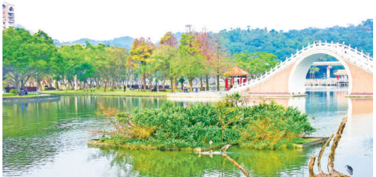
▲大湖公園的浮島是利用 PVC 管或竹子等浮水材料，與格子網、椰纖毯及沙質壤土相互結合組裝而成。(photo by 台北市政府提供)
