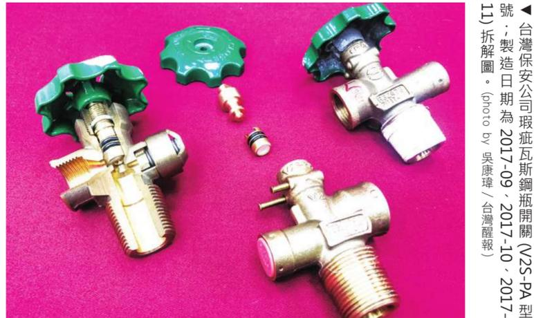
▲ 台灣保安公司瑕疵瓦斯鋼瓶開關 (V2S-PA 型號；製造日期為 2017-09、2017-10、2017-11) 拆解圖。(photo by 吳康璋 / 台灣醒報)
