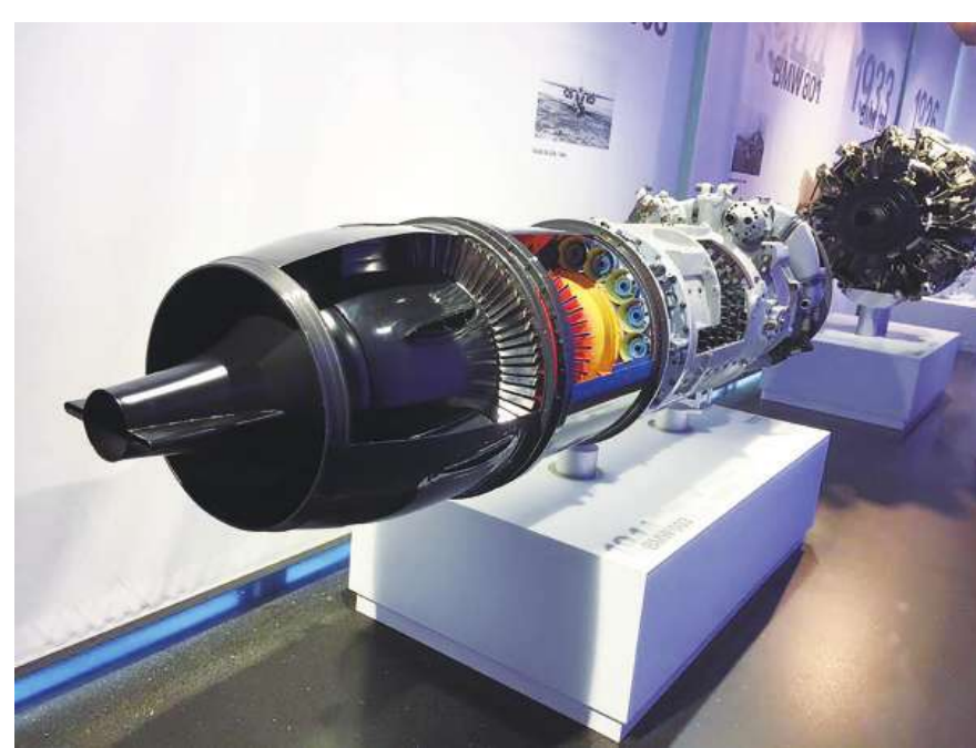
▲寶馬不是只製造汽車，也製造噴射機的渦輪引擎。飛機的渦輪葉片引擎是多層次增壓的。
