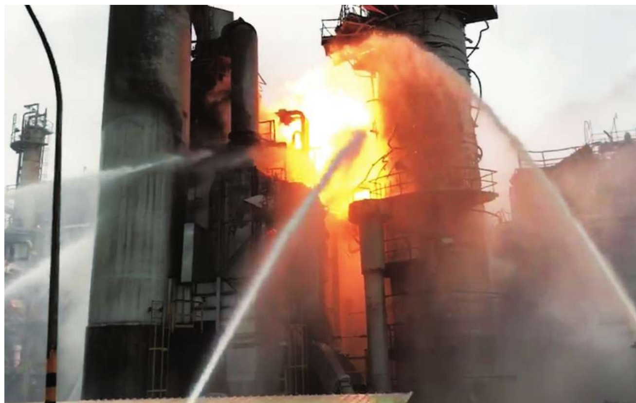
▲中油桃園煉油廠氣事故，消防局初查是加熱爐的爐管破裂起火燃燒，燃燒面積約 50 平方公尺。（中央社）
