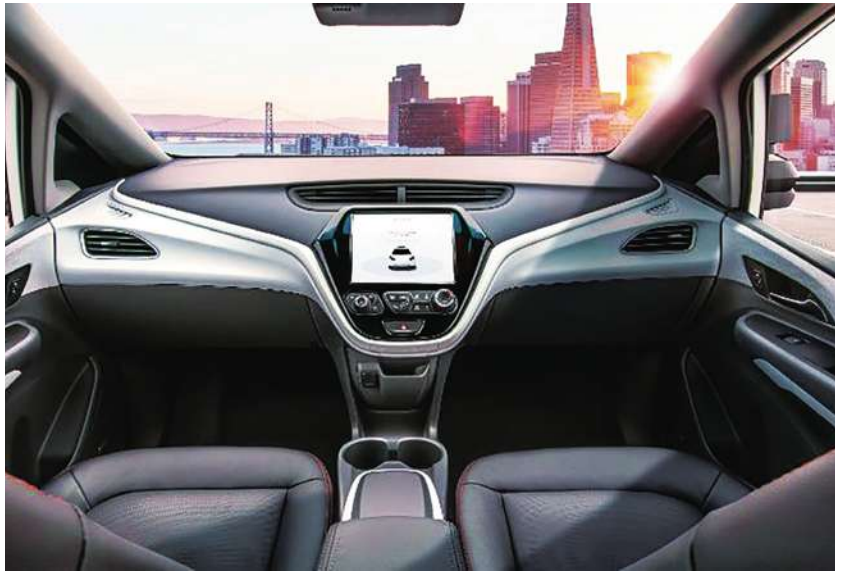
▲自駕車 Cruise AV，該車不但將方向盤移除，甚至剎車器、油門板傳統汽油車必備的功能都完全移除。（photo by Youtube 截圖）
