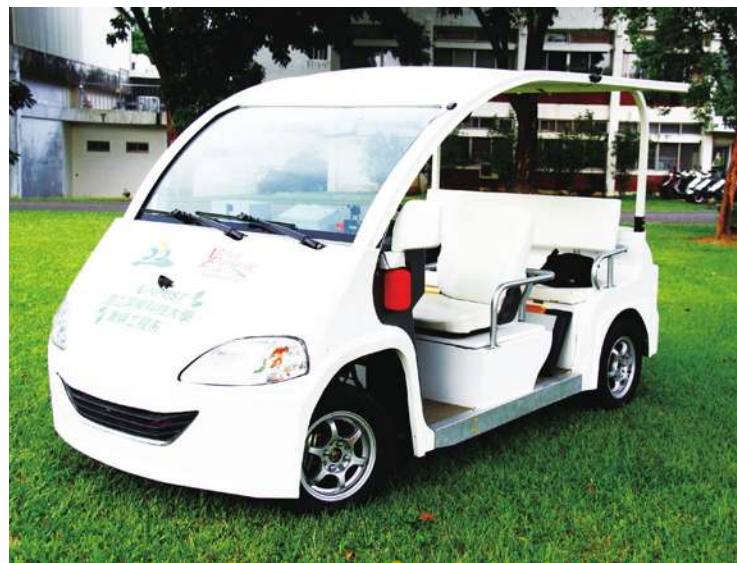
▲人口老化加速銀髮族產業的推動，屏東科技大學車輛工程系教授陳勇全團隊研發「高坡度高安全性智慧型福祉電動車」，讓輪椅也能上下車。（屏科大提供）
