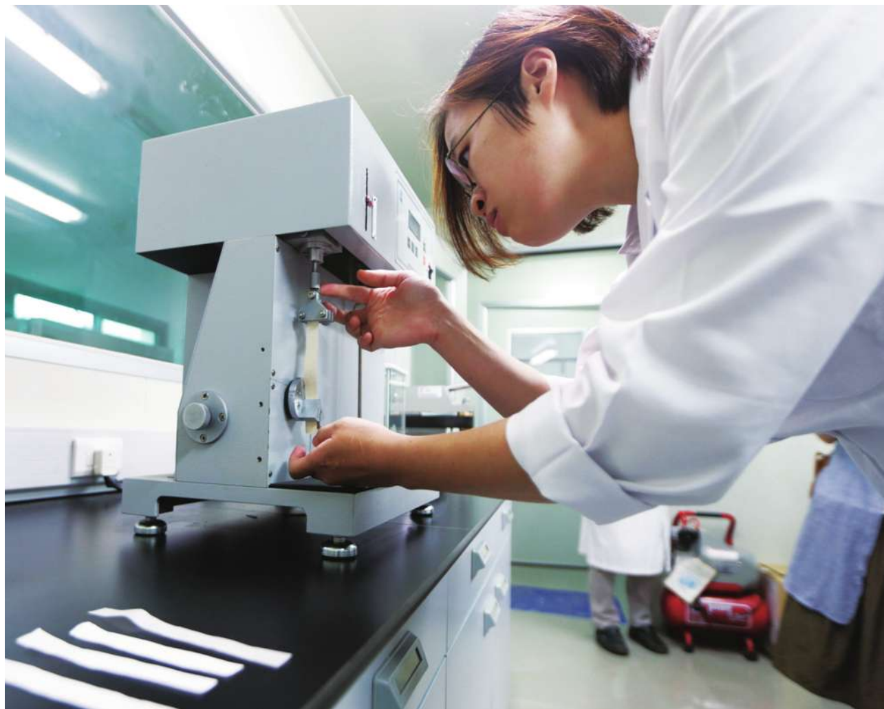
▲修復師除了不斷累積技術能力，認識「材料」也是工作的一環。圖為修復師在「材質劣化實驗室」使用強度試驗機比對各類紙張的強度，再評估是否與修復書畫相近。
