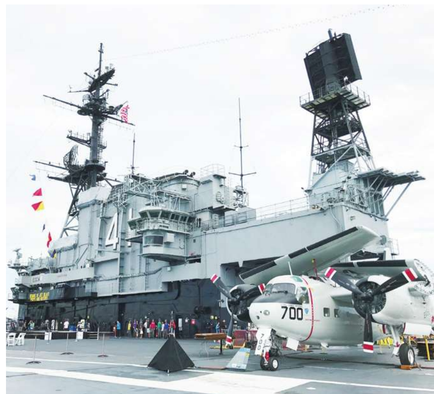
▲「中途島號」航艦位於甲板上的艦橋(Bridge)形狀像座小島，內部除了飛機控制塔台、航艦操控室、戰情中心還有艦隊司令室和艦長室等。
