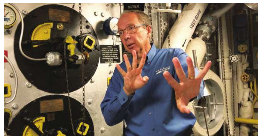
▲圖為中途島號航空母艦船艙底層的蒸氣鍋爐室(Boiler)，航艦是靠蒸氣帶動引擎，透過燃油把蒸氣鍋爐的水燒開，產生的蒸氣帶動渦輪推動扇葉，以此動力讓軍艦前進。
