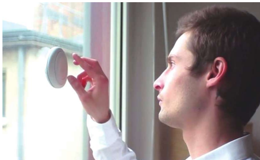
▲ 澳洲 INDUSTRIAL DESIGN 2 工業設計團隊設計一款抗噪裝置，已成功將窗外30至80分貝噪音抵消12分貝，並能自行偵測噪音類型。(photo by 網路截圖)
